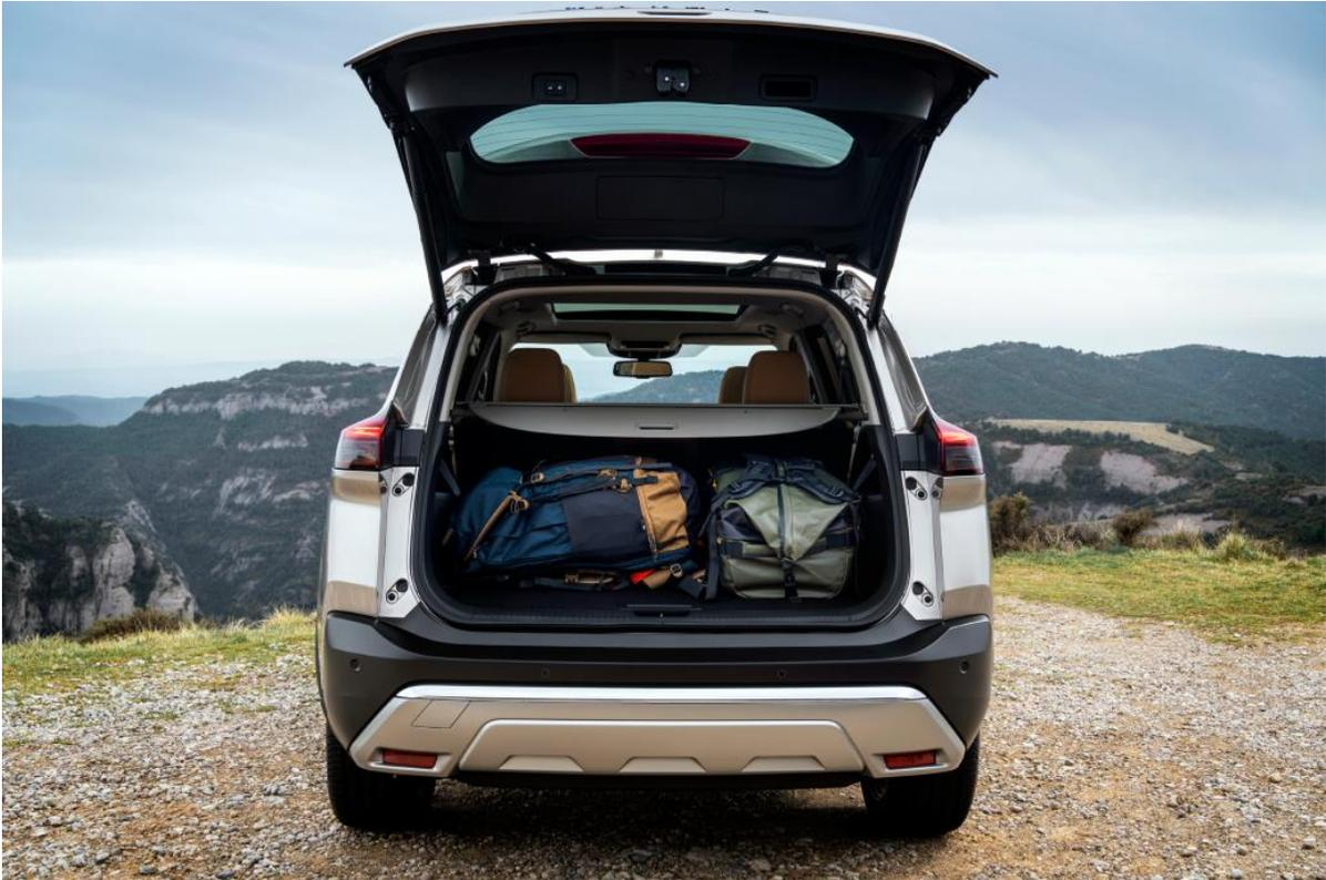
Die zweite Sitzreihe lässt sich im Verhältnis 40:20:40 umklappen. Die Durchladeluke in der Mitte ermöglicht den Transport längerer Gegenstände wie beispielsweise Skier, ohne die Sitze umklappen zu müssen. Die Sitze lassen sich auch nach vorne verschieben, um den Kofferraum zu vergrößern oder bei Siebensitzern den Zugang zur dritten Sitzreihe zu vereinfachen. Der äußere Sitz lässt sich dabei mit einem einfachen Handgriff nach vorne klappen.
